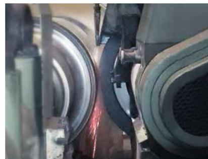
**+ Retificação de materiais extremamente duros:** O uso de rebolos CBN proporciona uma usinagem eficiente e econômica de cilindros extremamente duros como, por exemplo, cilindros HSS forjados.
