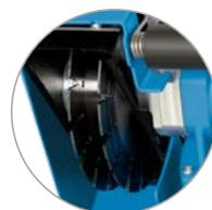
Conjunto de discos distanciadores com 3 lâminas fornecido para um destacamento mais rápido através da abertura central
