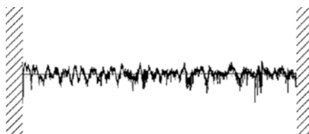
Superpolimento da superfície R_a = 0,051
