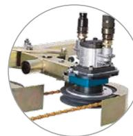
Motor de acionamento hidráulico padrão
